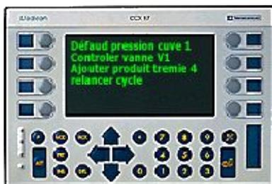
De plus en plus courant sur les machines basiques. Un afficheur texte et complété par un clavier alphanumérique.
