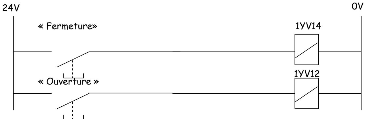
Câblage électro-pneu du système :
