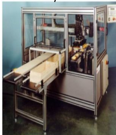
Met en place les couches de savonnettes séparées par des intercalaires, dans des boîtes en bois avec fermeture par couvercle .
